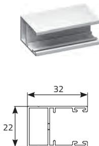
Führungsschiene mit Versetzprofil (gegen Mehrpreis)
