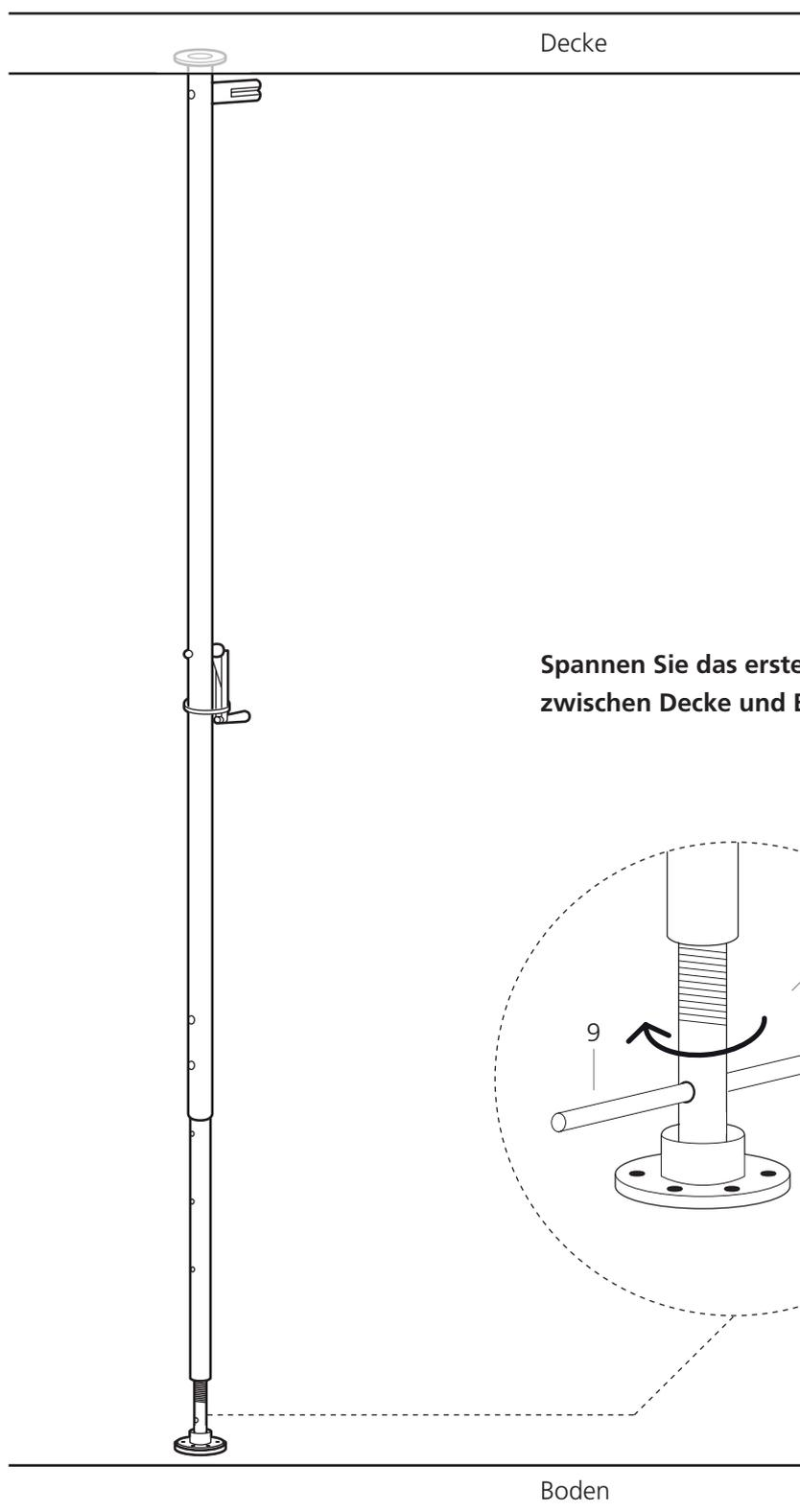
Spannen Sie das erste Standrohr zwischen Decke und Boden.
