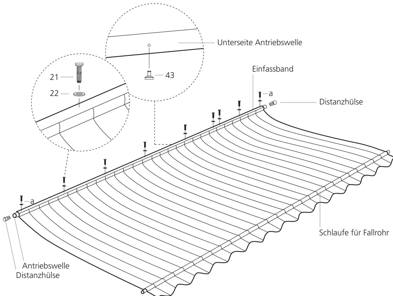
**Fallrohr:** Schieben Sie das Fallrohr in die vorgesehene Schlaufe und befestigen Sie das Rohr mit den beiliegenden Schrauben.
