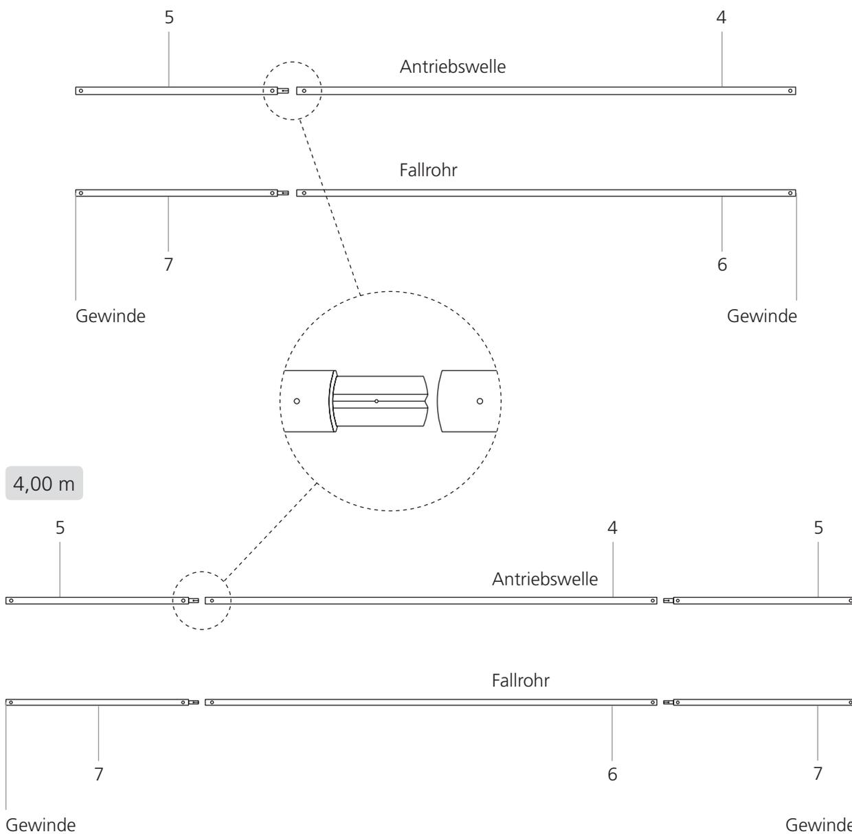
**Vor Montage des Markisentuches die Antriebswelle und das Fallrohr reinigen.**
