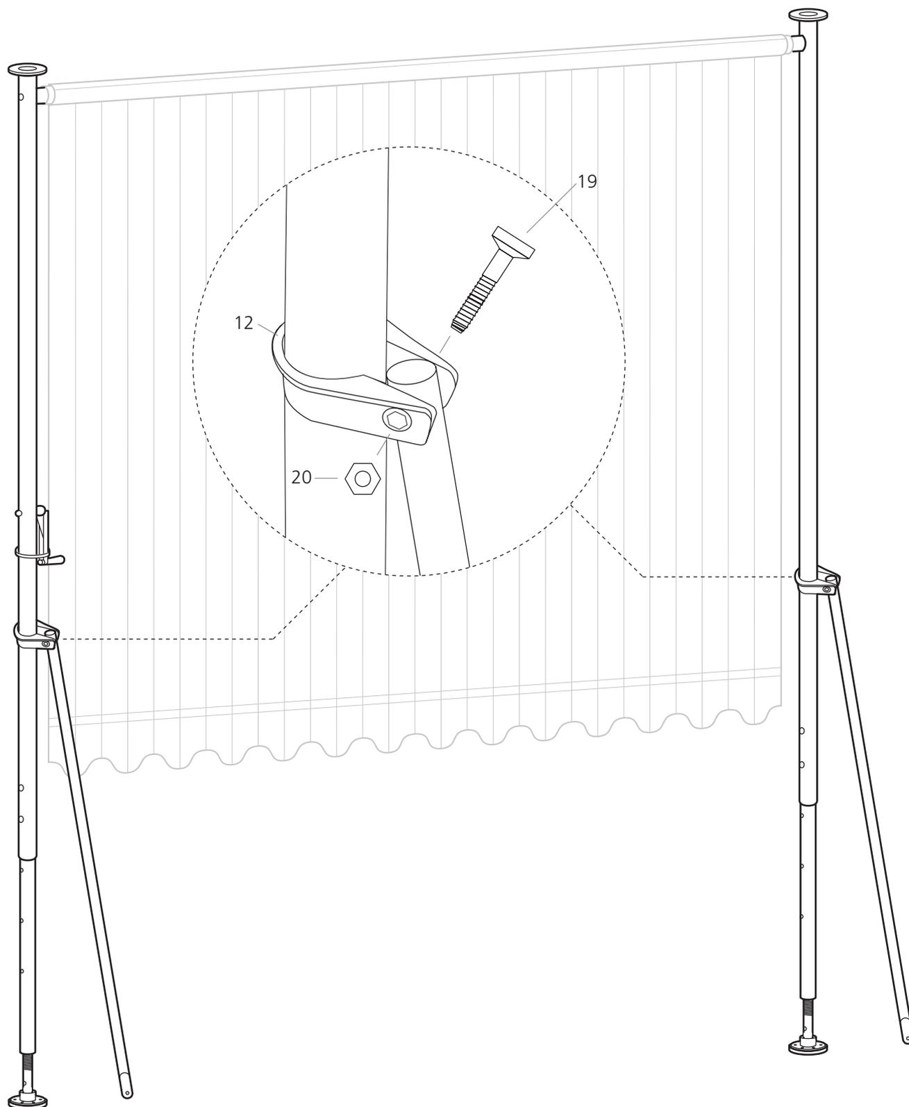
**Tipp:** Achten Sie bitte darauf, dass das Fallrohr waagrecht liegt (ggf. Höhe der Gelenke ändern). Mit Hilfe des Gummiringes kann die Kurbel und somit auch die Markise in jeder Position arretiert werden.
