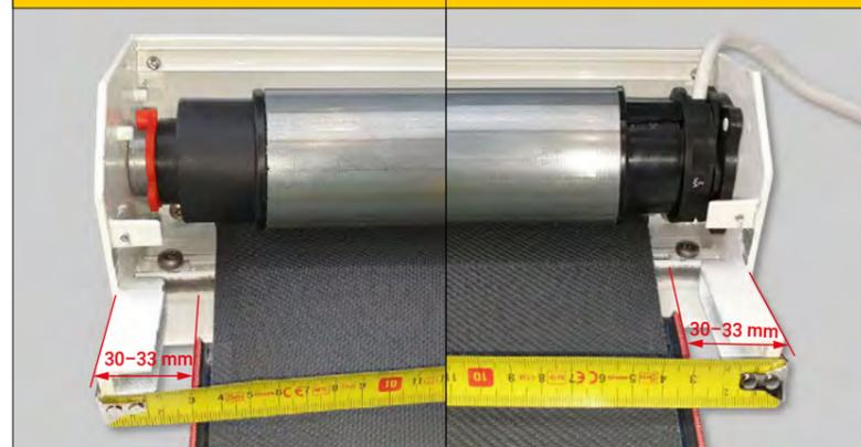
**32** Schließen Sie den Motor wieder an das Montagekabel an. Entfernen Sie den Schutz von den Klebebändern.
