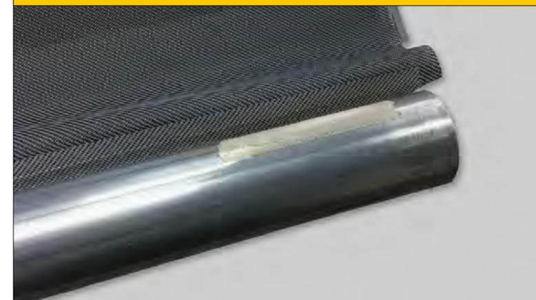
**12** Kleben Sie an die Stelle des alten Klebebandes ein neues doppelseitiges Klebeband an. Die Klebeseite nicht lösen!
