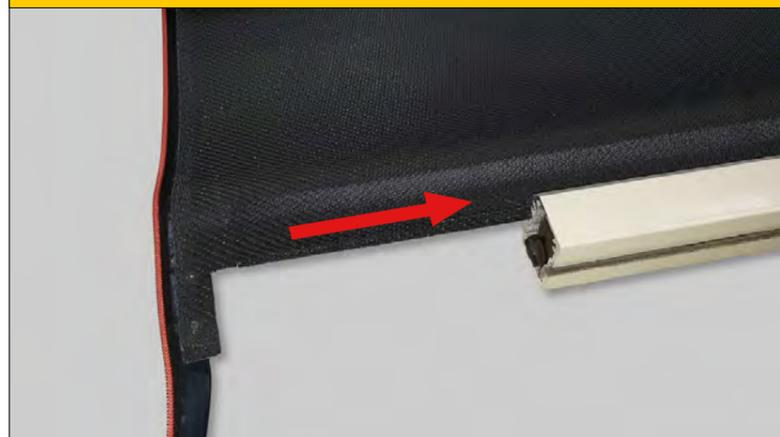
**26** Positionieren Sie den Stoff symmetrisch – in gleichen Abständen von den Kanten der Unterleiste. Schneiden Sie den Stoff genau bis zum Rand der Unterleiste ein.
