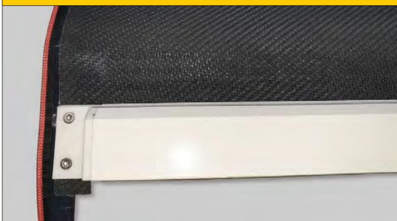
**16** Lösen Sie die Schrauben, mit welchen der Stoff an der Unterleiste befestigt ist und demontieren Sie diese.
