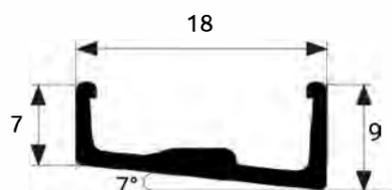
Alluminium Schräge Bodenschiene
