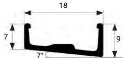
Alluminium Schräge Bodenschiene
