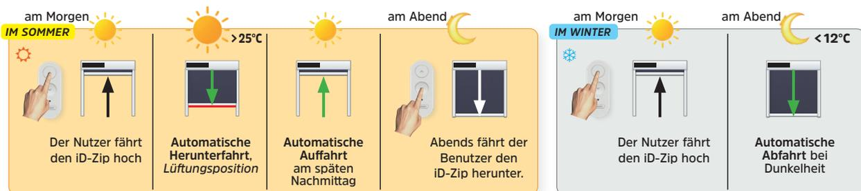
Die automatische Steuerung kann einfach durch längeres Drücken der **Bubendorff-Taste** ein- und ausgeschaltet werden:
